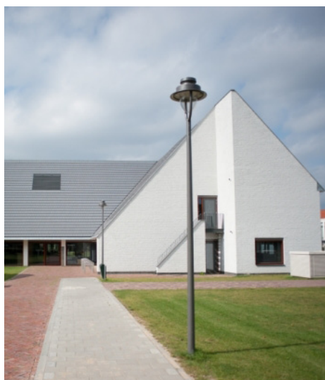
Paaltoparmatuur langs fietsroute: Albany-LED (Schreder) 4.00m Paaltop (kleur RAL 7016)
