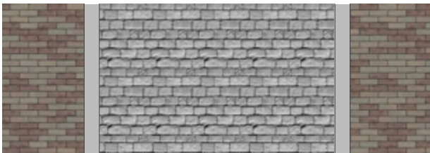
Loopstrook: Ardeche (40%), Burano (60%); Halfsteensverband Middenloper: Granieten kasseien, kleur: natuurlijke variatie binnen bandbreedte grijs tot gemeleerd
