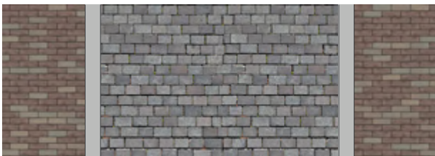
Loopstrook: Ardeche (70%), Burano (30%); Halfsteensverband Middenloper: Granieten kasseien, kleur: natuurlijke variatie binnen bandbreedte grijs tot gemeleerd
