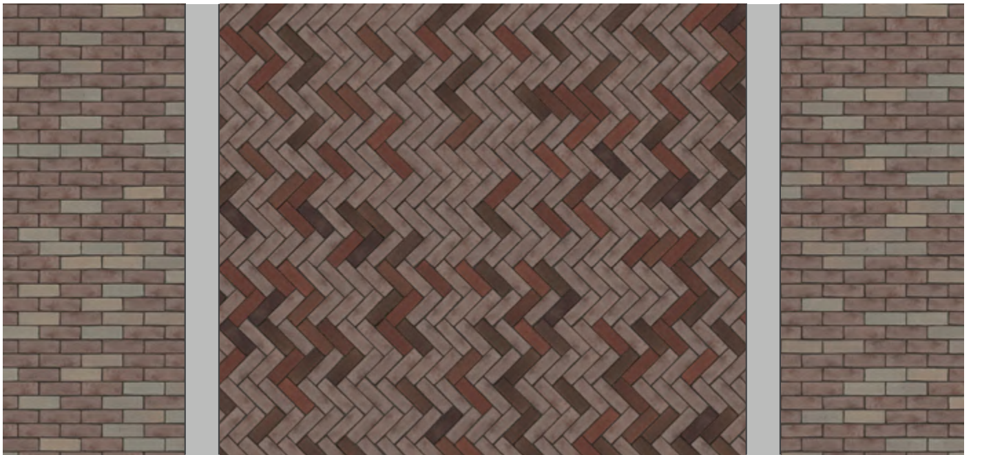
Loopstrook: Ardeche (70%), Burano (30%); Halfsteensverband Middenloper: Ardeche (70%), Autunno (30%); Keperverband ; Bron: Textuurgenerator, Van der Sanden
