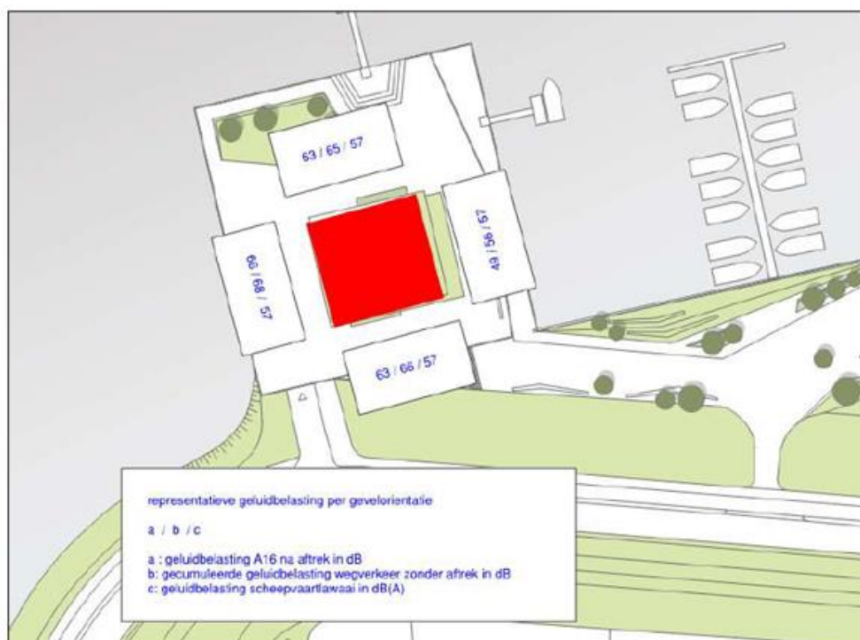
Figuur 1 Samenvatting optredende geluidbelasting (notitie Waterside te Rotterdam Akoestische onderbouwing stap 3 besluit (Documentnummer 18306.0316-01- 2019) Geen gevel van de geplande woontoren heeft een goede of redelijke akoestische kwaliteit. Drie gevels hebben een slechte akoestische kwaliteit, één gevel een matige.
