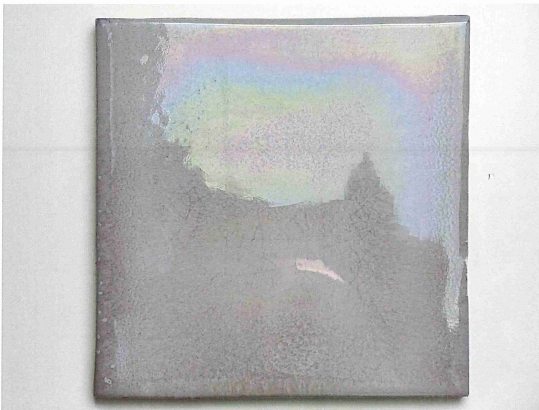
Foto 24: Fijne haarscheuren in craquelé patroon in een eerder niet gebruikte tegel.
