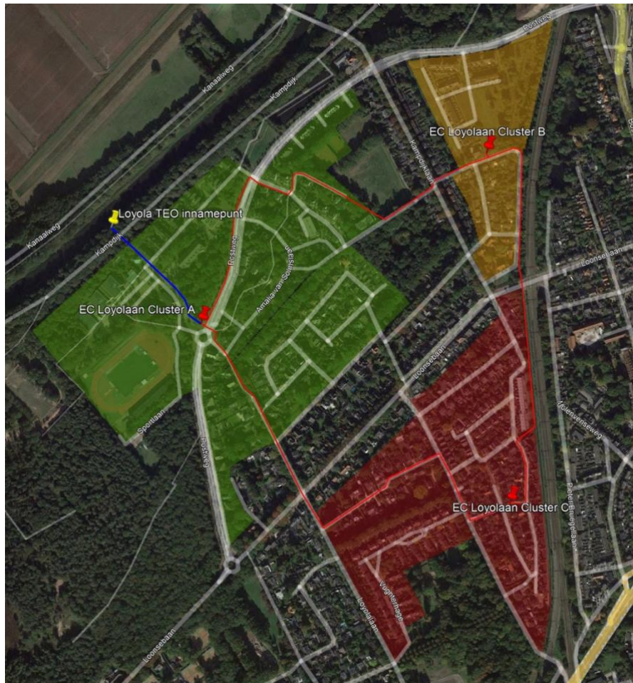
Figuur 14: Satellietbeeld met clusterleiding die sectoren verbindt (rode lijnen), clusterleiding voor inname TEO (blauwe lijn), locaties ondergrondse energiecentrales (rode pins) en innamepunt TEO (gele pin)
