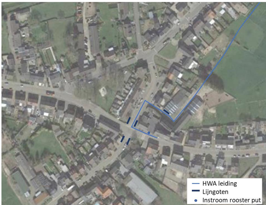
Figuur 2: Aangesloten lijngoten op HWA-leiding
