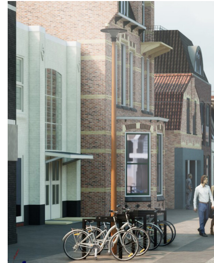
verlichting paaltoparmaturen, lph 4m houten mast, armatuur ntb
