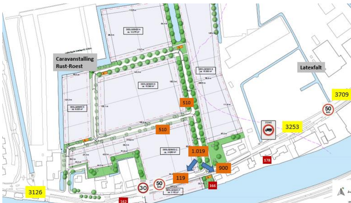
Figuur 3 Overzicht uitgangspunten akoestisch onderzoek met algemeen/autonomoos wegverkeer (geel) en extra verkeer bedrijventerrein (oranje). Rijsnelheid 'huidige bebording' zonder uitvoering verkeersbesluit 2018.
