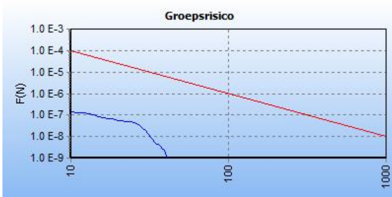
Figuur 5.1 FN curve voor 1440_leiding-W-522-05-deel-1 van N.V. Nederlandse Gasunie voor de kilometer tussen stationing 26100 en stationing 36100
