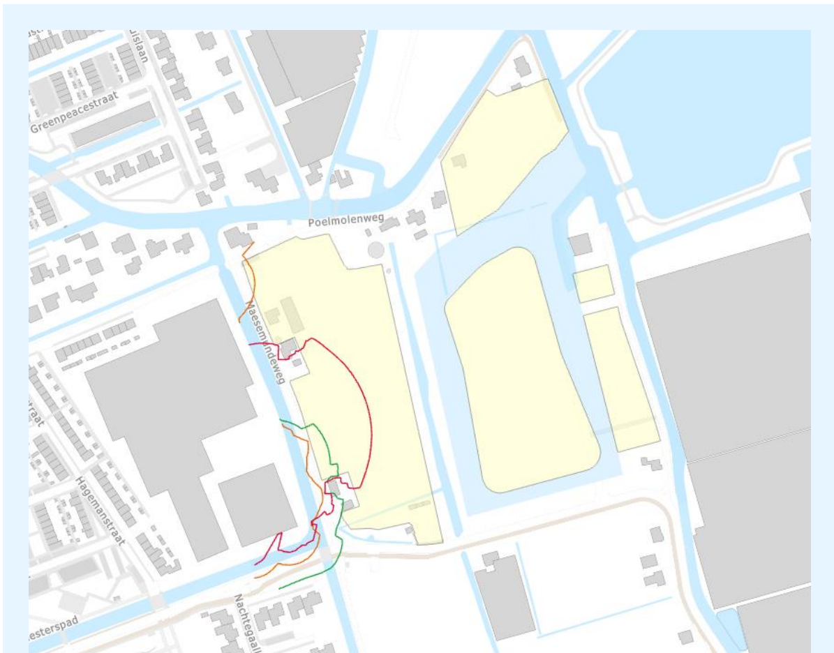
figuur B1.5: 60, 65 en 70 dB(A) contour van het maximale geluidsniveau op een hoogte van 5 meter. Dag, Avond en Nacht. 60 dB(A) (groen), 65 dB(A) (oranje), 70 dB(A) (rood).
