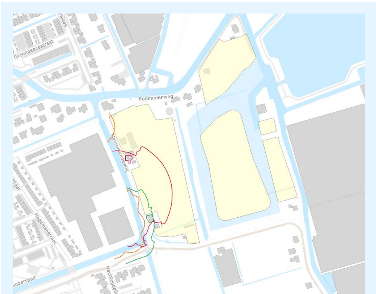
figuur B1.6: 60, 65 en 70 dB(A) contour van het maximale geluidsniveau op een hoogte van 7.5 meter. Dag, Avond en Nacht. 60 dB(A) (groen), 65 dB(A) (oranje), 70 dB(A) (rood).
