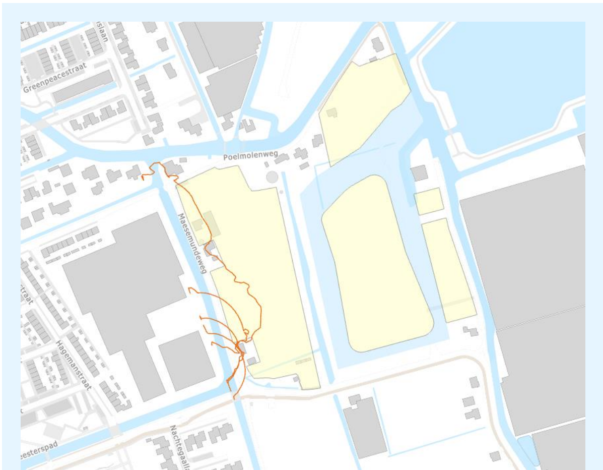
figuur B1.2: 50 dB(A) etmaalwaarde contour per bedrijf (oranje) op een hoogte van 5 meter
