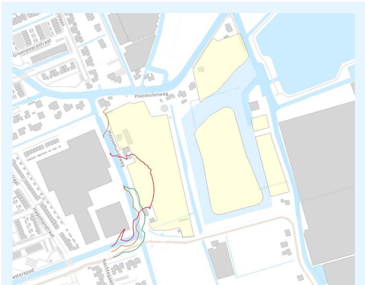
figuur B1.4: 60, 65 en 70 dB(A) contouren van het maximale geluidsniveau op een hoogte van 1.5 meter. Dag, Avond en Nacht. 60 dB(A) (groen), 65 dB(A) (oranje), 70 dB(A) (rood).
