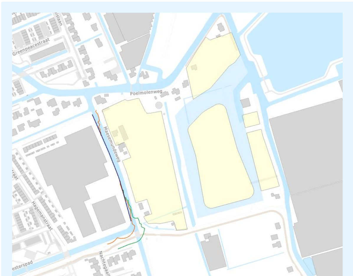
figuur B1.11: 60, 65 en 70 dB(A) contour van het maximale geluidsniveau op een hoogte van 7.5 meter. Dag, Avond en Nacht. 60 dB(A) (groen), 65 dB(A) (oranje), 70 dB(A) (rood).
