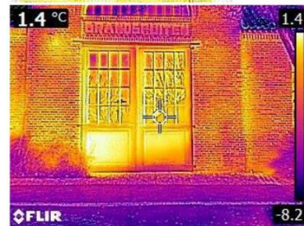
Klokkengieterijpand. Geel /rood geeft warmteverlies aan.
