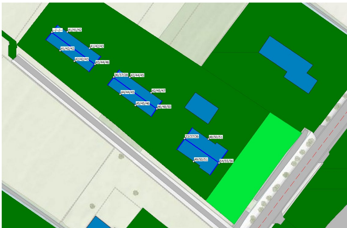
Afbeelding 5. Geluid L_{den} Gemeentewegen Berekend geluid op een hoogte van 2,0 ; 5,0 en 8,0 meter
