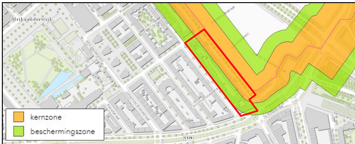
Afbeelding 6: Aanwezige waterkering ter hoogte van plangebied (rood omkaderd).
