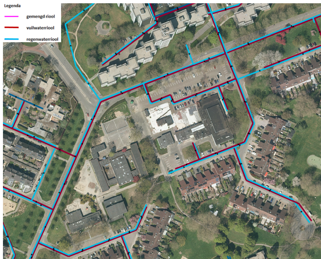
Figuur . Overzicht riolering.
