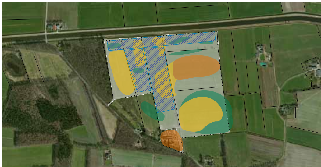
Afbeelding 38. Invulling vlakken en waterberging naar aanleiding van het reliëf (oranje = hoog, blauw = laag)
