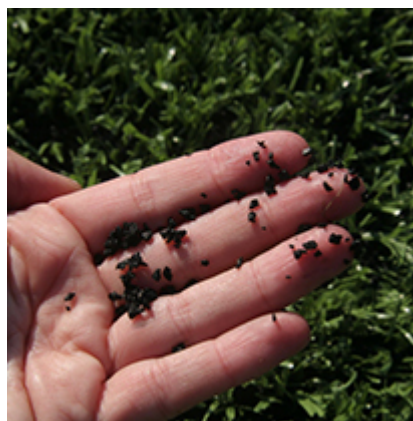
Figuur 1 Rubbergranulaat als instrooimateriaal op een kunstgras-sportveld
