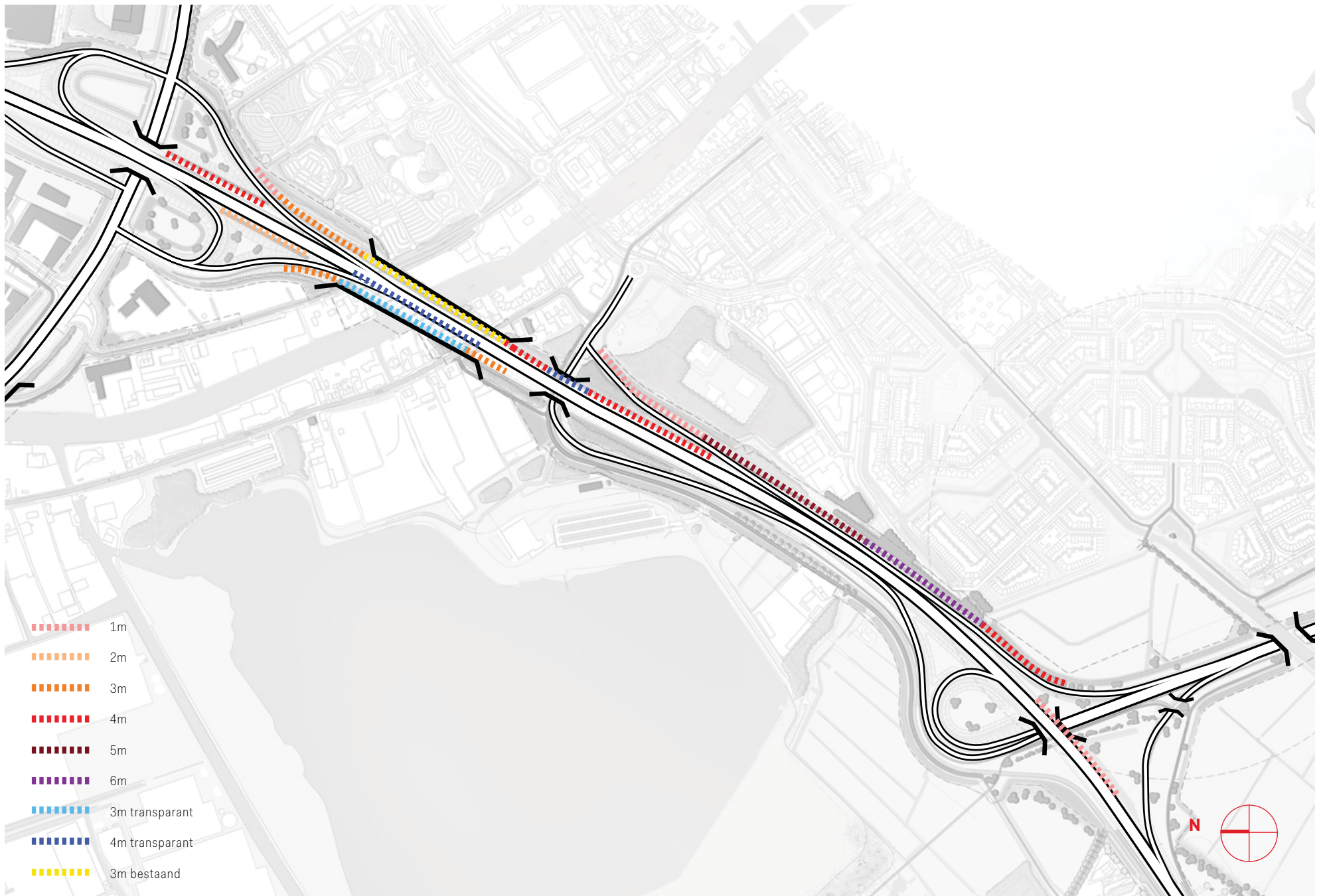
↑ UITSNEDE LANDSCHAPSPLAN RIJNLANDROUTE MET EEN SCHEMATISCHE WEERGAVE VAN DE GELUIDSSCHERMEN MET HOOGTEAANDUIDING.
