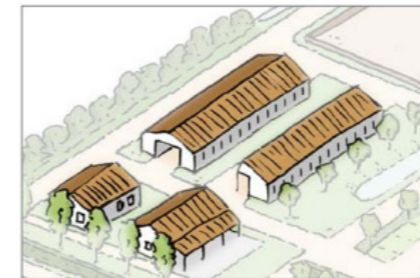
Bijgebouwen in eenzelfde stijl en materialisering, in detailering ondergeschikt aan het hoofdgebouw
