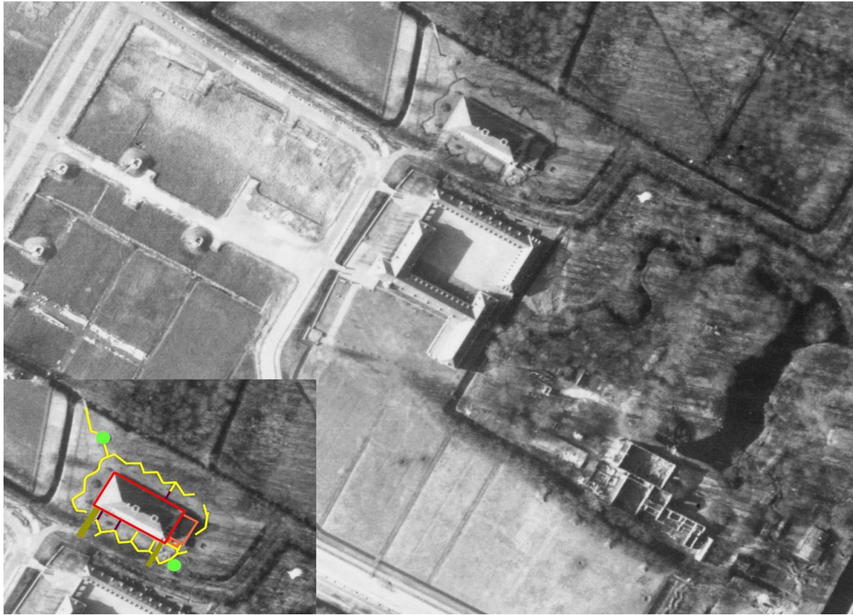
43. Luchtfoto van de RAF van 26 februari 1945, waarop de rond de bunker aangelegde loopgraaf goed zichtbaar is. Op de inzet is herkenbare deel met geel aangegeven. De twee groene stippen zijn de Tobruks. De bruine vlakken zijn de toegangswegen tot de bunker. Met paars zijn de overwelfde toegangsgangen aangegeven. (Herkomst: www.watwaswaar.nl )
