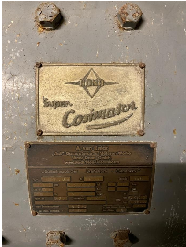
15. Generator 2 van de firma A. van Kaick uit 1956. Dit is het machineplaatje:
