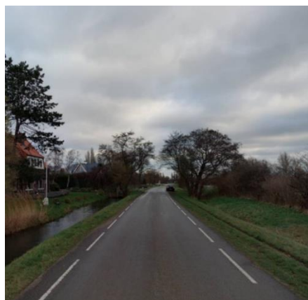
Figuur 8. Ideale inrichting erftoegangsweg buiten de bebouwde kom (ETW-1/60 km/u-zone, CROW publicatie 315) met hogere verkeersintensiteit
