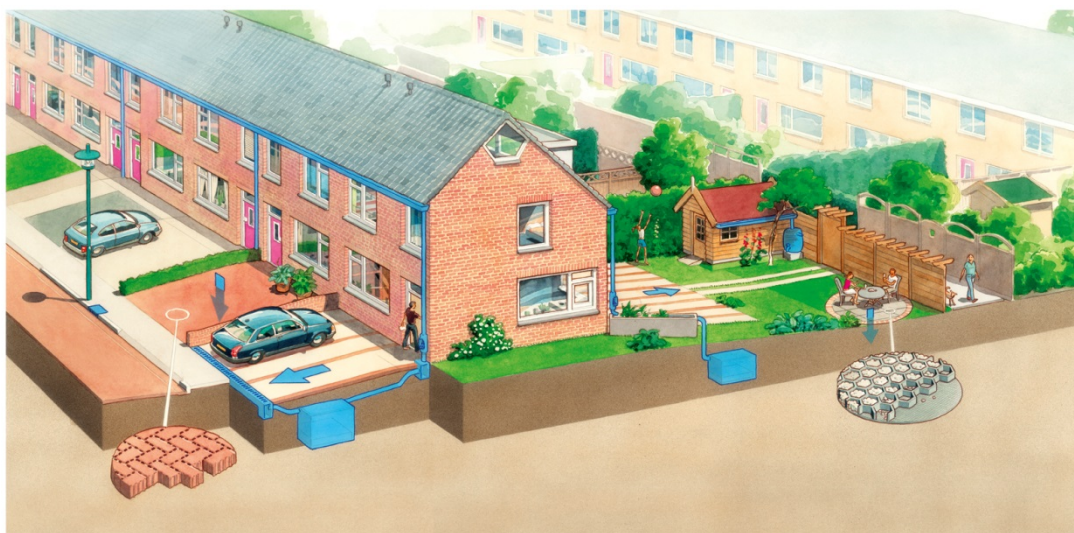
Figuur 5.8.2. Illustratie afkoppelen verharding (bron Rioned)
