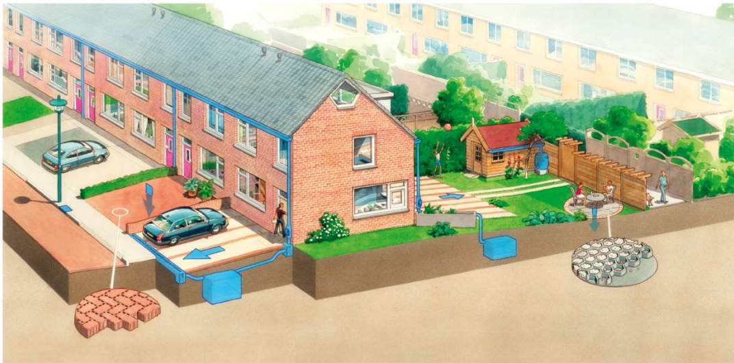
Figuur 5.8.2. Illustratie afkoppelen verharding (bron Rioned)
