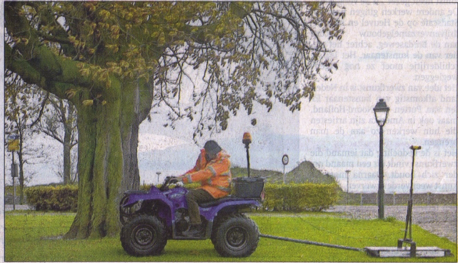
• Archeologie nieuwe stijl: Dick van der Roest rijdt met een quad over het Wilhelminaplein. Achter de vierwieler hobbelt een radarapparaat mee, dat de grond scant. FOTO: JOHAN WOUTERS
