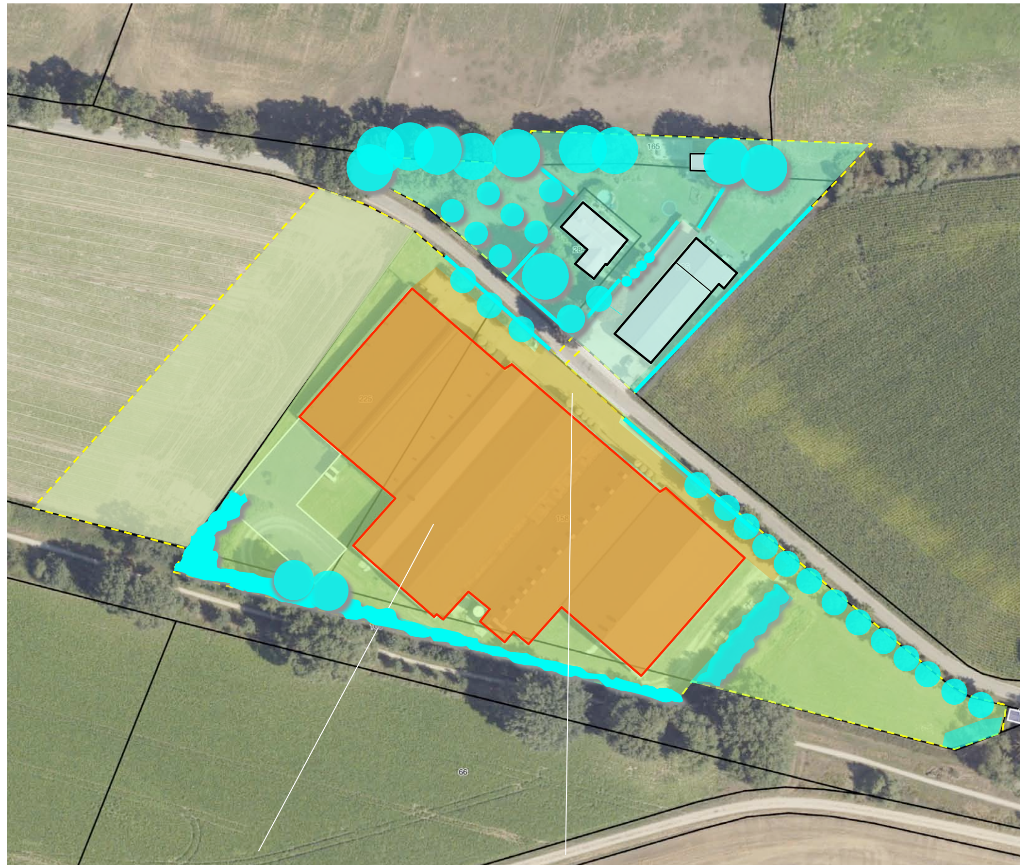
te slopen stallen en te verwijderen verhardingen
