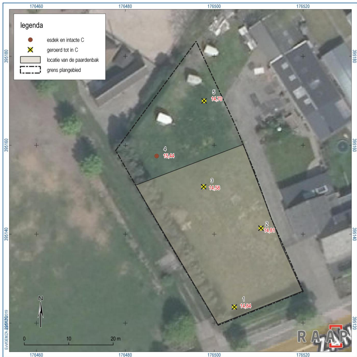
Figuur 9. Resultaten verkennend booronderzoek. In rood staat aangegeven tot welke diepte de bodem is verstoord in meters boven NAP.
