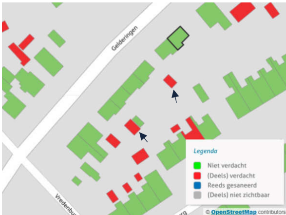
Afbeelding 2.1: Asbestdakenkaart provincie Overijssel. Op de onderzoekslocatie staan twee schuurtjes met een asbest verdacht dak (aangegeven met zwarte pijltjes).
