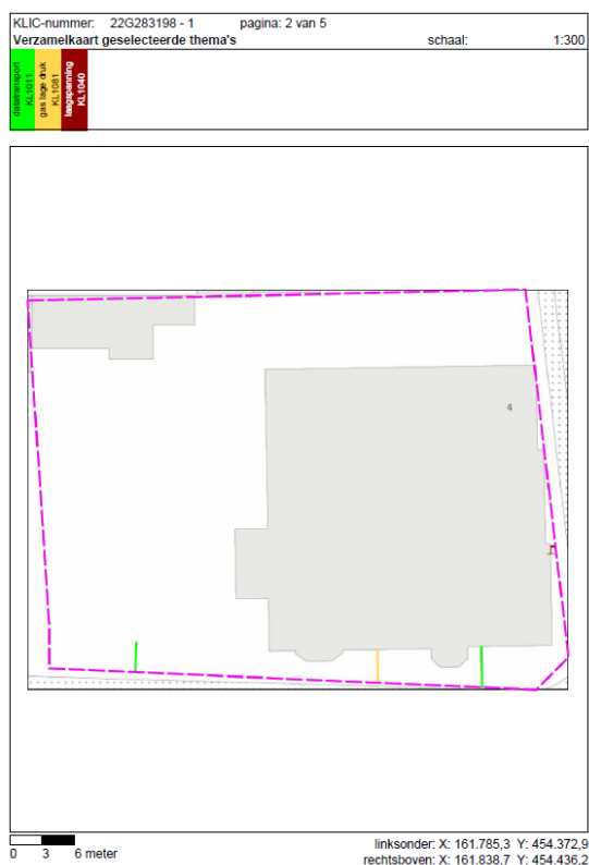
Afbeelding 12: KLIC melding plangebied. In het groen is datatransport aangegeven, in geel gas en in roodbruin laagspanning.
