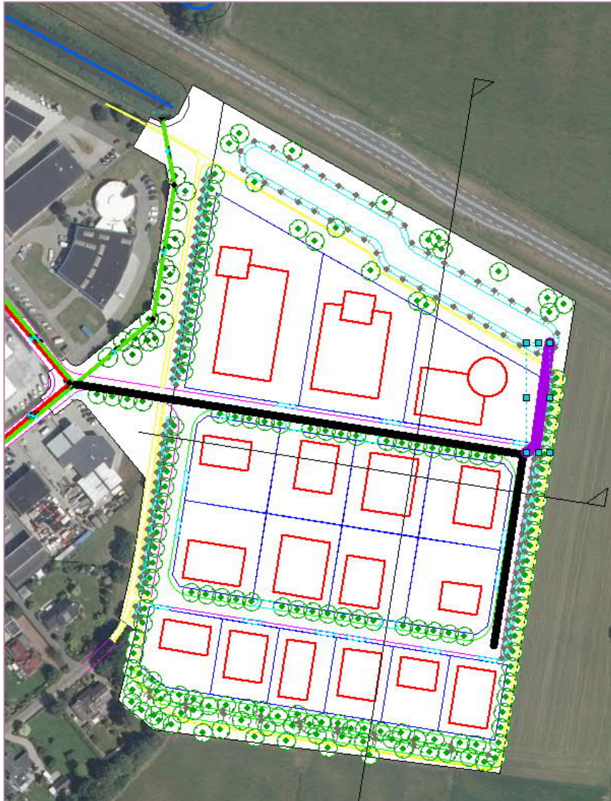
Figuur 4.3 Langste afstand hemelwaterstelsel/DWA stelsel (zwart) en voorstel aanvullende overstortleiding (paars)
