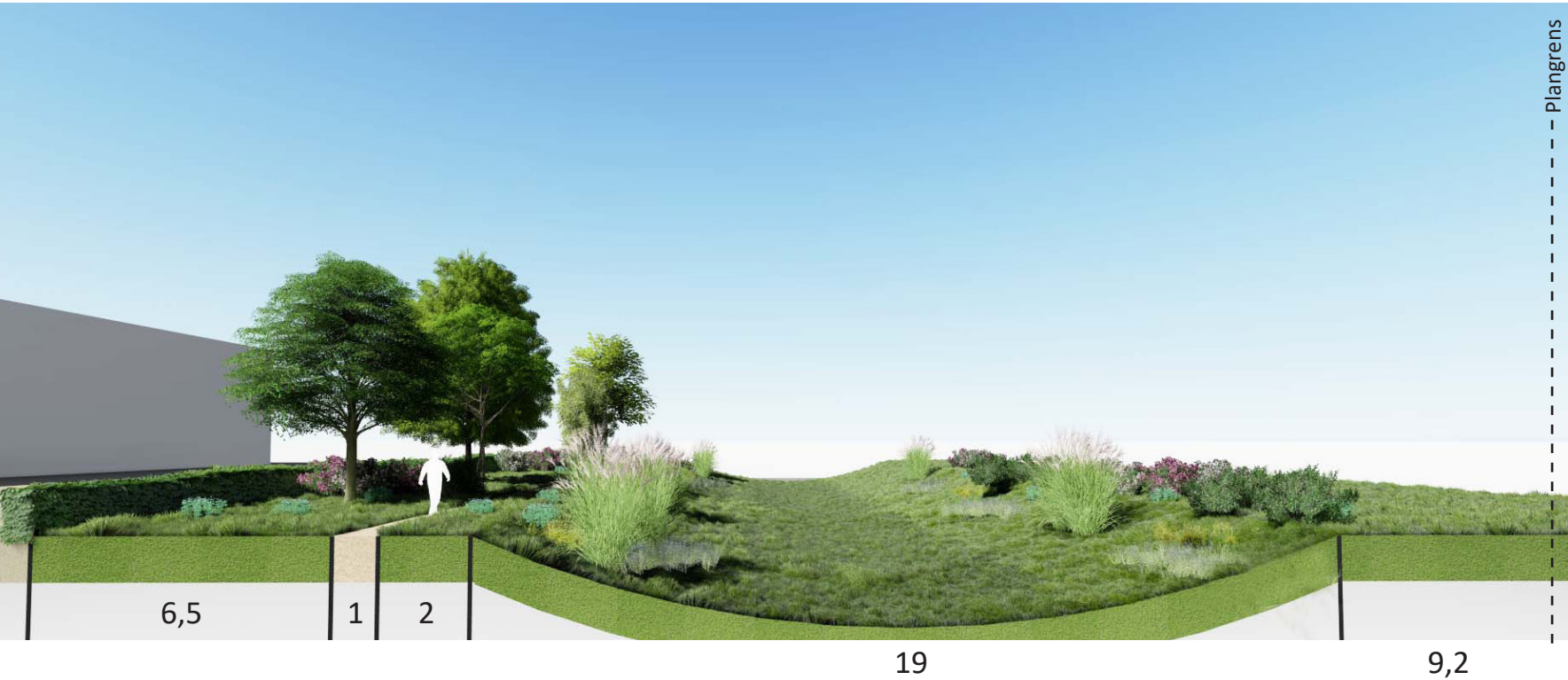
Doorsnede over noordelijke groenstrook: struipad loopt meanderend tussen het bedrijventerrein en de waterberging (droogvallende wadi) de talud zijn flauw en worden ingericht met natuurvriendelijke oevers representatieve voorzuides van de bedrijven zijn op de N35 gericht
