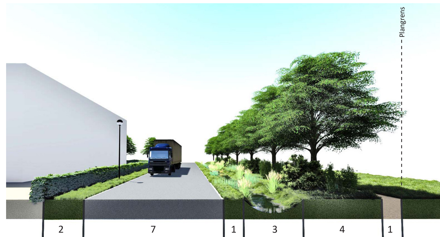
Doorsnede over oostelijk groenstrook (Lentheweg): 5 meter brede groenstrook met bomenlaan en struipad beëindigen het bedrijventerrein zaksloot voert het water naar de waterberging aan de noordzijde
