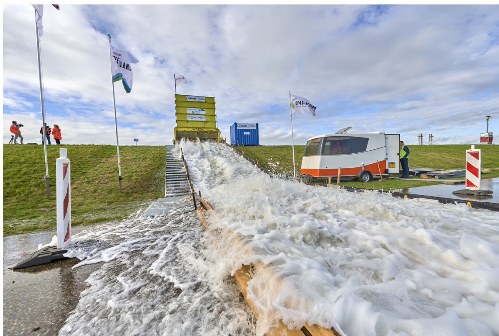
Figuur 13 Golfverslagsimulatie tijdens overslagproef IJsselmeerdijk
