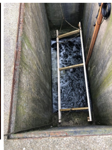
Figuur 24: proefopstelling beluchter in persbuis gemaal
