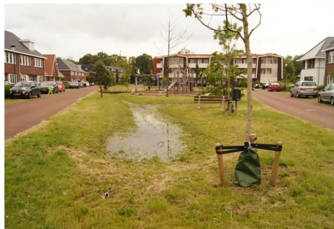
Figuur 3 Voorbeeld van een wadi: een groene maatregel om regenwater tijdelijk vast te houden en te laten infiltreren
