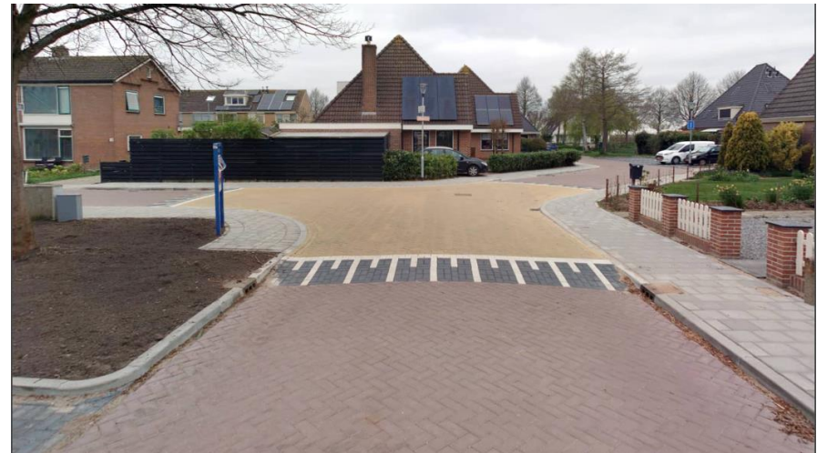
Figuur 7 Kruising, rijbaan en plateau als een standaard ETW bibeko. Locatie: Balkweiterhoek Zwaagdijk-West.
