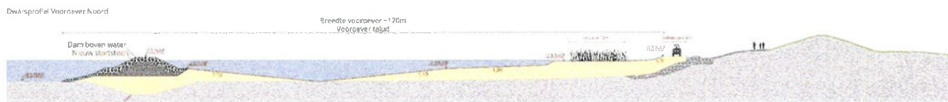
Figuur 2: Dwarsdoorsnede van het referentieontwerp op het traject Meerdijk-Noord
