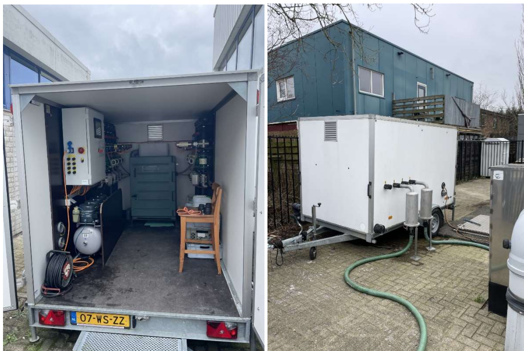
Figuur 28: Bemonsteringskar t.b.v. strengenonderzoek op de waterzuivering.
