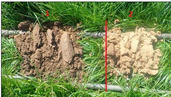
Afbeelding 19. Foto van boring 12, waarbij 1: bouwvoor (matig grof zand), 2: rivierduin (matig grof zand)
