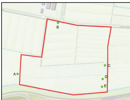
Afbeelding 10. Boringen uit het Dinoloket in (de directe omgeving van) het onderzoeksgebied. Boring A= klei op veen op klei/zand, boring B, C, D= klei op zand, boring E= zand met leem-/klei (bron: www.dinoloket.nl )
