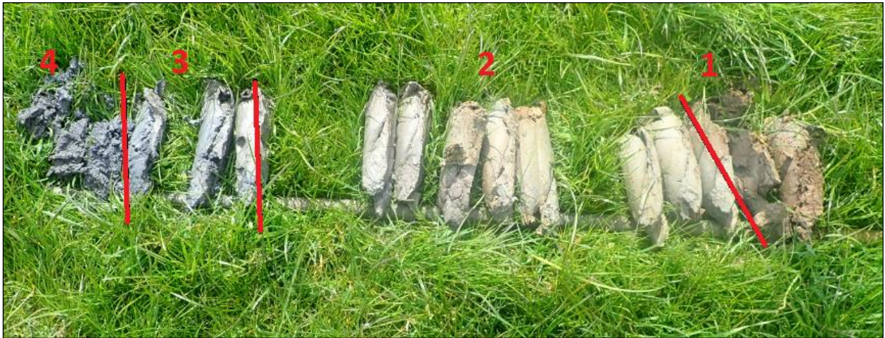
Afbeelding 18. Foto van boring 110, waarbij 1: bouwvoor, 2: komafzetting (matig siltige klei), 3: verspoeld zand met klei (sterk zandige klei), 4: rivierduin (matig grof zand)
