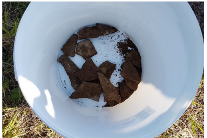
Foto 4: asbestverdacht materiaal SL101
