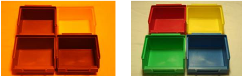
Foto: vier bakjes Links met oranje verlichting waardoor de bakjes allemaal rood/oranje lijken. Rechts met witte verlichting waarmee je de echte kleuren kan zien.
