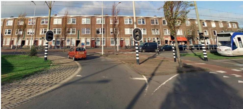
Figuur 2.2: Tweekleurige verkeerslichten bij rotonde Apeldoornselaan - Dierenselaan
