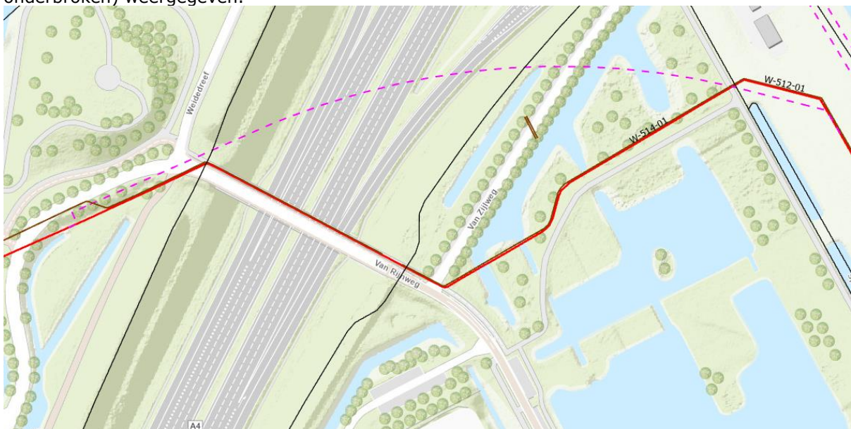
Figuur 2 Locatie te verleggen leiding (paars is nieuw, rood is bestaand, bruin is vervallen)
