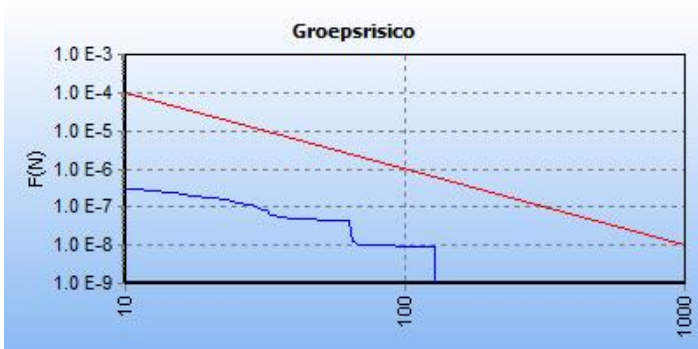
Figuur 17: De fN-curve voor deze kilometer leiding (leiding W-514-01 inclusief de verlegging).
