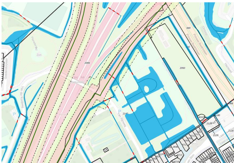
Figuur 7: Waterkering met in het roze een waterstaatswerk en in het groen de beschermingszone van de waterkering
