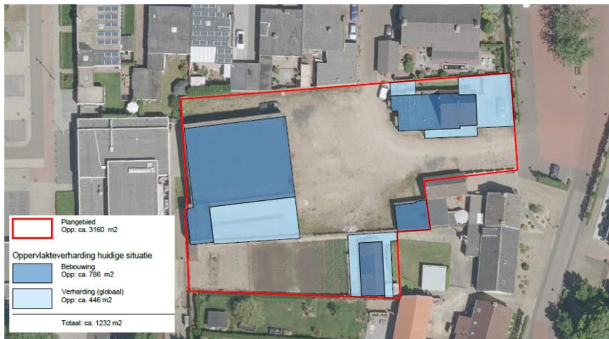
Afbeelding 23: Huidige situatie verharding perceel Markt 8 en 8a
