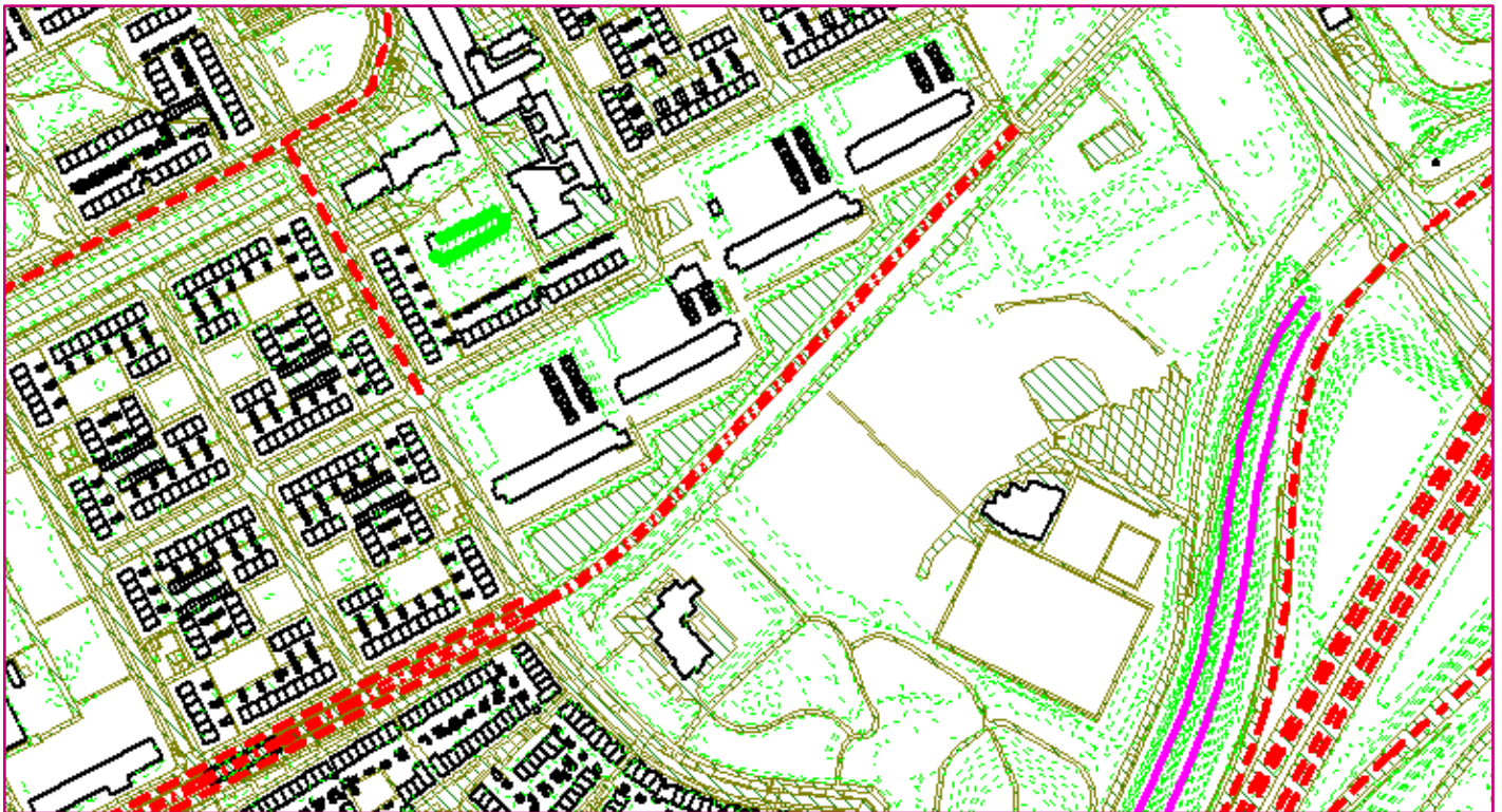
Figuur 4.1 Overzicht van het akoestisch rekenmodel met de ligging van objecten, bodemvlakken en de toetspunten
