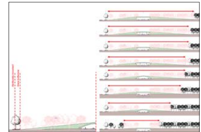
hoogte in relatie tot de taludlengte
