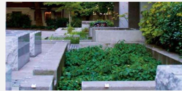
Infiltratiestroken met bovengrondse en ondergrondse opslag
