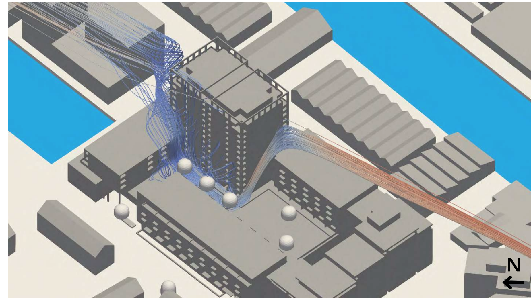
Figuur 5.3: Stroomlijnen westelijke hoek Blok A bij wind uit de richting ZZW, inclusief vegetatie. Stroomlijnen gekleurd naar snelheid, waarbij rood een hoge snelheid en blauw een lage snelheid aangeeft.
