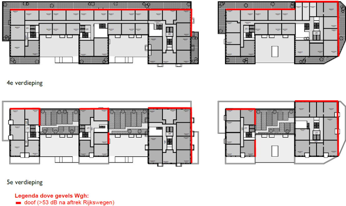
Figuur 4.3: Dove gevels op de 4 e en 5 e verdieping (bron: akoestisch onderzoek Burgemeester Elsenlaan 329 Buro Bouwfysica)
