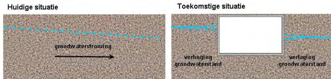
Figuur 1.1 Schematische weergave van barrièrewerking op grondwaterstroming
