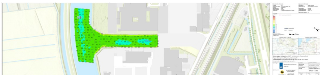
Afbeelding 4.5 Bodempeiling eind 2023 [ref. 6] - 2 e Insteekhaven
