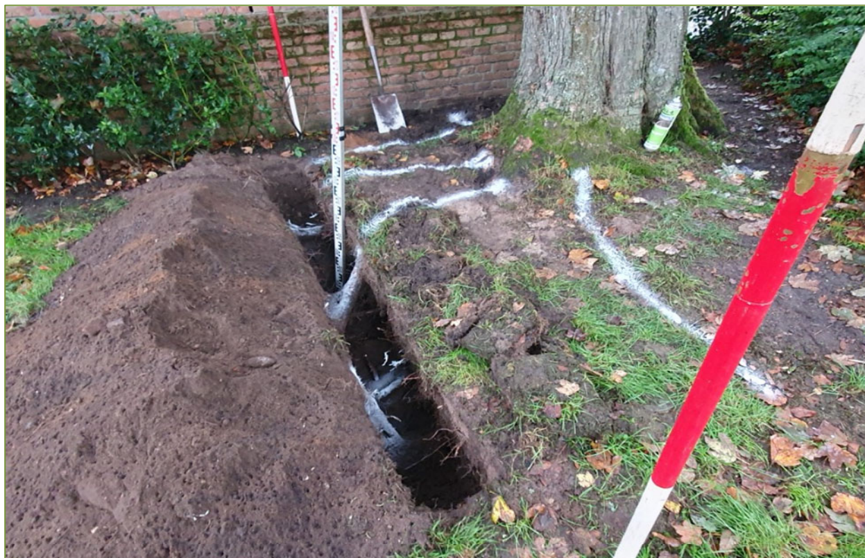
Figuur 10: Gemiddeld bodemprofiel trottoir
