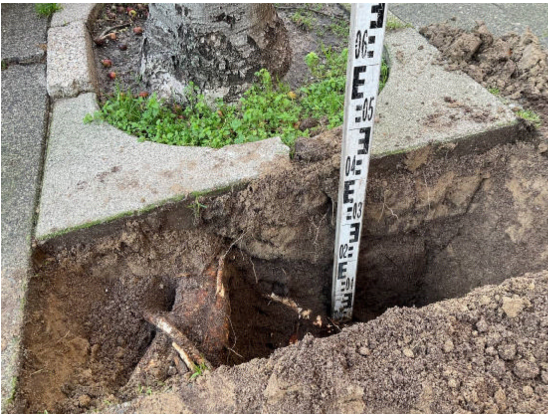
Foto 8: Beeld van intensieve beworteling onder de stoep van de sierappel met boomnummer 97 aan de Dr. Kruyterstraat.
