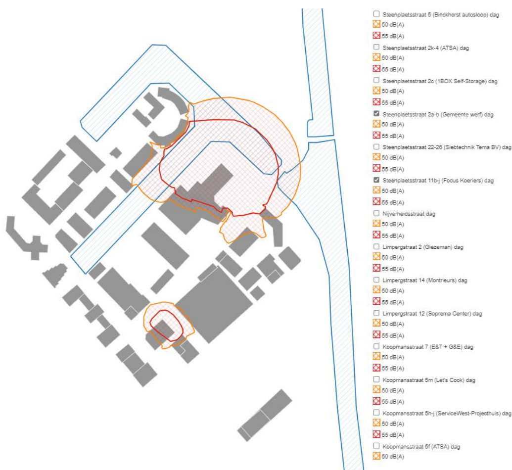
f.3.1 Voorbeeld equivalente 50 dB(A) en 55 dB(A)geluidcontouren in de dagperiode op een rekenhoogte van 5 m boven het maaiveld.
