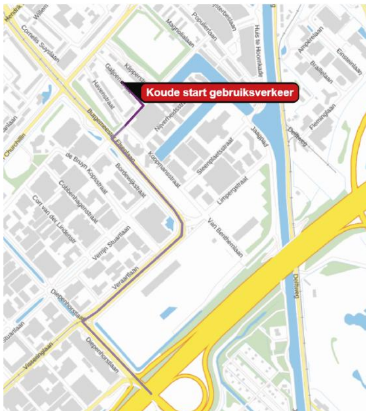
Figuur 8: Gemodelleerde bronnen in de gebruiksfase bij de Galjoenstraat. De vlakbron is voor de koude start en mobiele werktuigen. Type lijnbronnen: lichtpaars = doorstromend, paars = normaal en donkerpaars = stagnerend. Bron: AERIUS.
