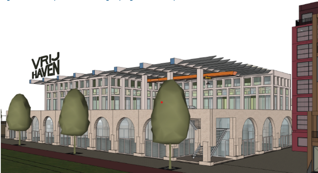
Figuur 10 - Principeschets verhoogde pergola met PV op dak
