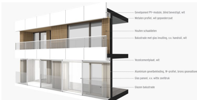
Figuur 13 – Principeschetsen PV in de gevel
